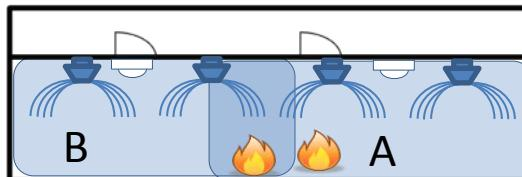
2つ以上のユニット(図ではA、Bの2つ)で警戒し、連動して同時に放射することで消火性能を保障
