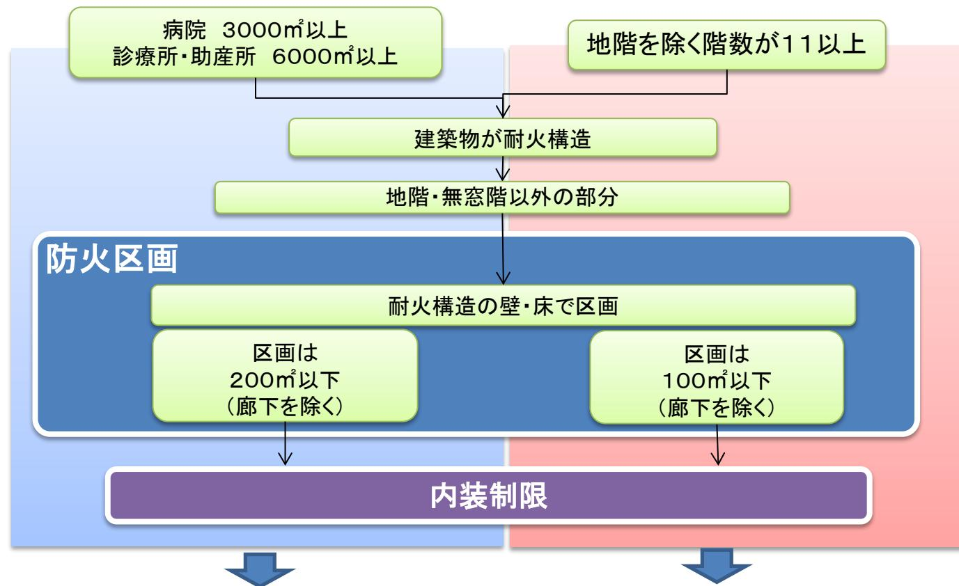
区画・内装の部分の面積をスプリンクラー設備設置対象面積から除外し、3000m<sup>2</sup>又は6000m<sup>2</sup>以上であれば、区画・内装以外の部分に設置
