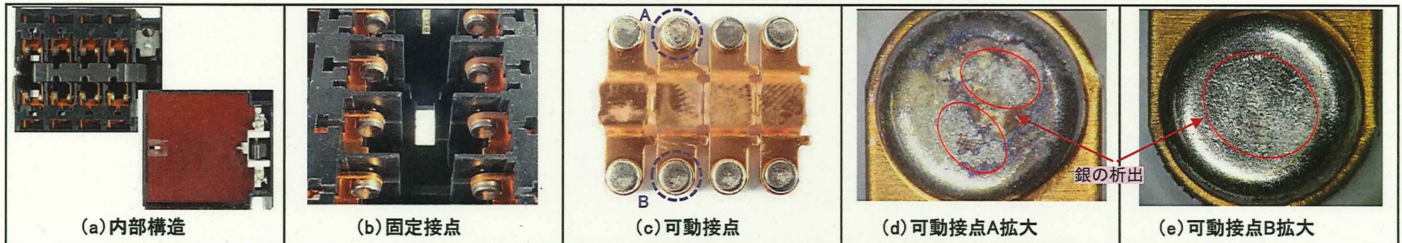
写真6 電磁接触器 (BKCC) の内部写真
